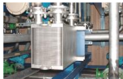
SIGMAWIG ST12 system reaktora chemicznego olej grzewczy / glikol etylenowy
