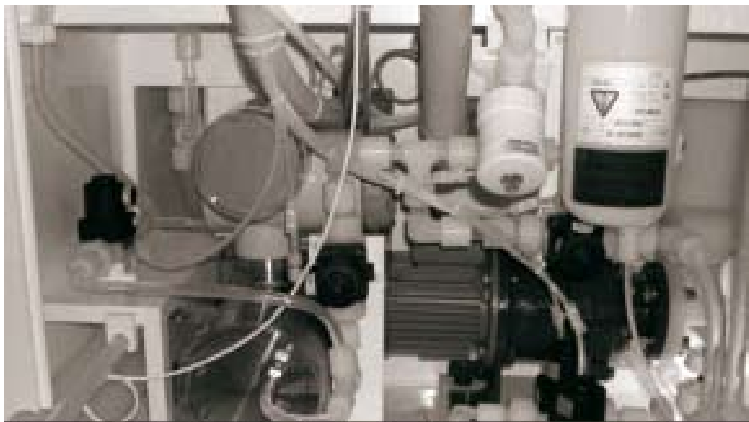
Kąpiel wytrawiająca z NaOH i KOH
