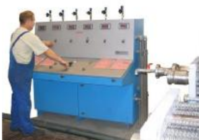
Próba ciśnieniowa płyt po remoncie
