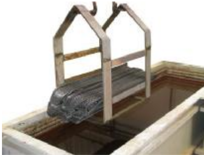
Czyszczenie chemiczne płyt
