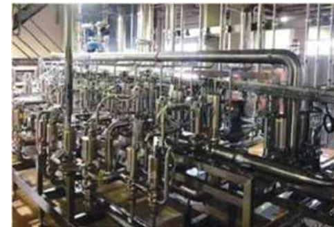
Fot. 3. System mieszania obejmujący maksymalnie 13 strumieni płynnych produktów
