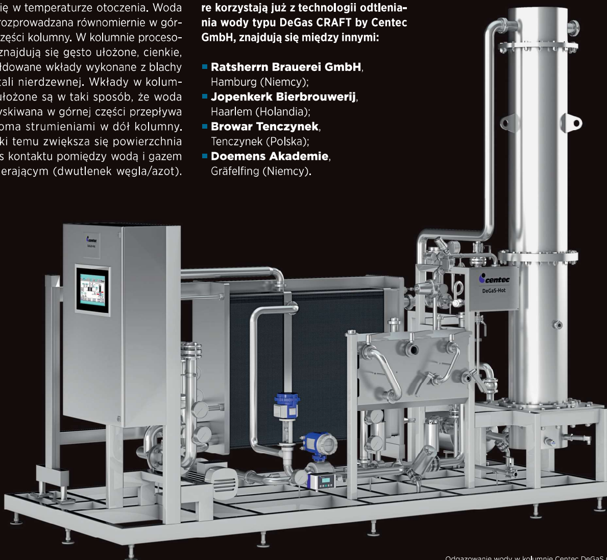
Odgazowanie wody w kolumnie Centec DeGaS CRAFT.
